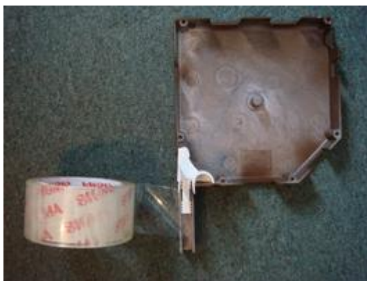
Рис. 2.2. Установка направляющего устройства в боковую крышку
