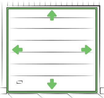
Секционные ворота «АЛЮТЕХ» по всему периметру оснащены эластичным резиновым уплотнителем на основе полимерного каучука. Боковой и верхний уплотнители имеют два лепестка. Это способствует лучшей тепло- и звукоизоляции ворот.
